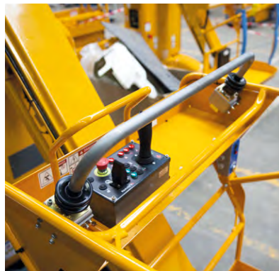
Haulotte Activ'Shield Bar (układ zapobiegania zgnieceniu)
